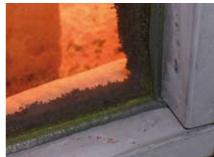
Der Fireblock schäumt zuerst auf der feuerzugewandten Seite auf.
