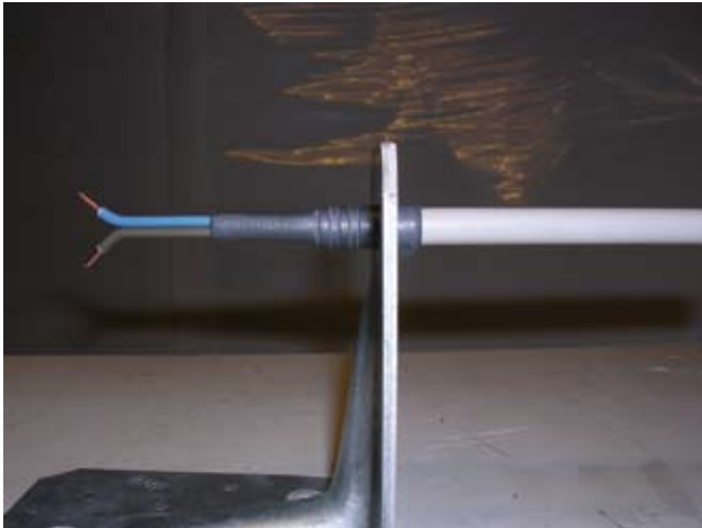
Einsatz von FIREBLOCK in Schaltschränken/Kabeldurchgang.
