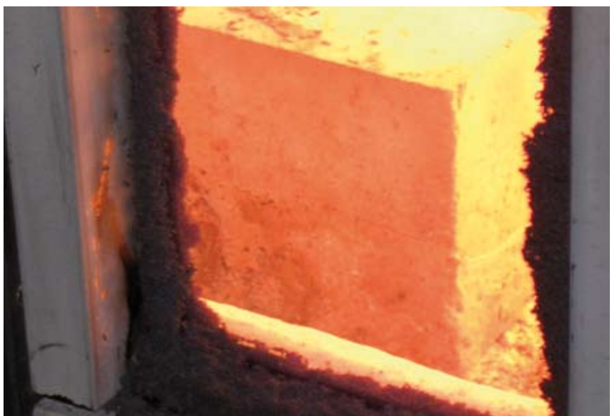
Im Versuchsverlauf ist das FIREBLOCK-Profil auf beiden Seiten aufgeschäumt und wirkt als Hitzeschild.
